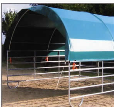
Die Folie wird mittels den Spannern so weit durchgeholt, daß ein Schlagen oder Flattern der Folie ausgeschlossen ist. Zum Schluß werden die Spannbänder der Giebelüberhänge straff gezogen und mit der Waagerechten des Elementes verbunden.
